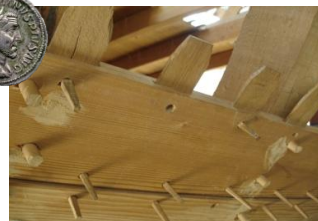
Por menor da técnica construtiva tipo concha . Museu de Marselha
